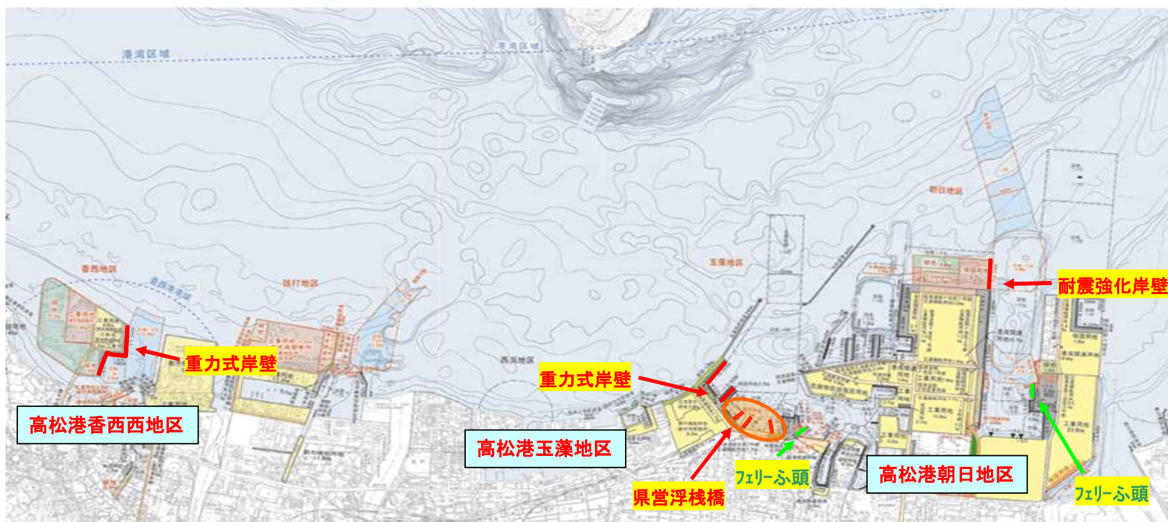
図 応急復旧対象とする岸壁、浮棧橋
