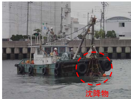
▲揚描船による沈降物の揚収状況
