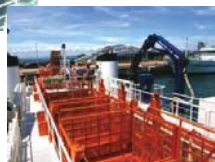
▲ゴミ回収コンテナ
