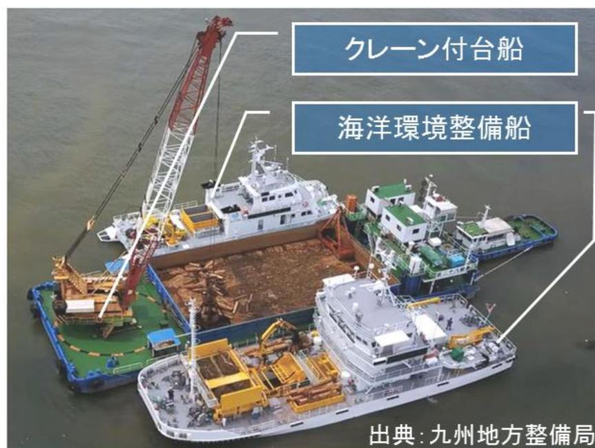
クレーン付台船を用いた漂流物の回収作業
