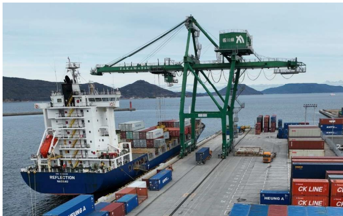
インバータ制御方式のガントリークレーン (平成25年度完成)
