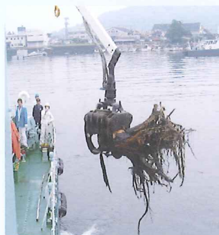
多関節クレーンによる流木回収 門形クレーンによるごみの移動
