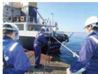
GNSS 測量機設置状況
