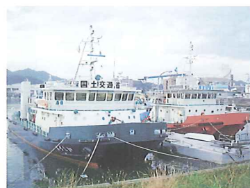
当所棧橋にて海面清掃兼油回収船2隻の雄姿。 写真左が「いしづち」、右が「おんど2000」。 船首に見える赤い放水銃で油の拡散作業を行う。
