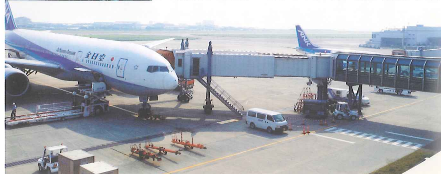
松山空港の様子。写真右上の白い建物の前を到着したコンテナ貨物運搬車が走る。左下の車両は離陸前の大型機に載せるコンテナを運んでいる。貨物車のほか、燃料車など(左上)、GES通路はこのような車両の交通に利用されている。
