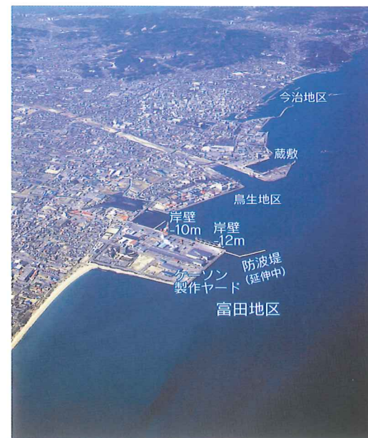
「富田新港」の名で親しまれる今治港富田地区は平成7年度より岸壁2バースが供用開始されています。翌年ガントリークレーンが設置された水深-10m岸壁ではコンテナ貨物が、水深-12m岸壁では現在主に石膏の荷役が行われています。定期航路が外貿(韓国)4便/週、内貿3便/週就航しています。
