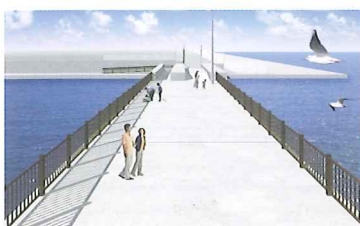
▲富田地区防波堤イメージ図 防護柵、照明設備やスロープを備えた防波堤
