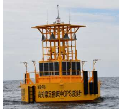
【GPS波浪計設置状況】
