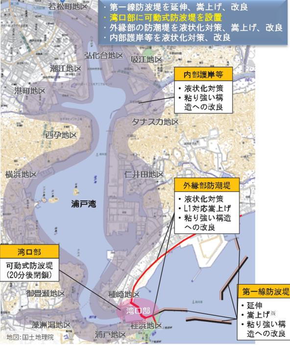
※ 第一線防波堤の嵩上げについては、別途地震時の地盤沈下量を求め、地震後においても港内の静穏度を確保するのに必要な高さに事前対策するものとした。なお、河川堤防については、液状化対策済みとして設定し、地殻変動による沈降量のみを考慮した。
