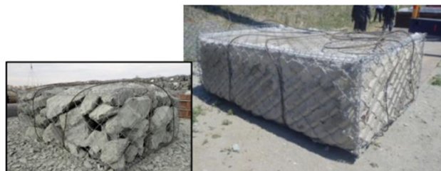
かごに砕石を中詰め かごにカルシア改質土を充填
