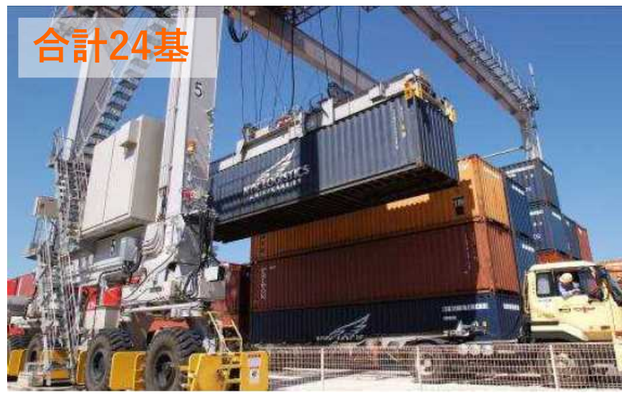
③遠隔自働RTGがコンテナの積卸
