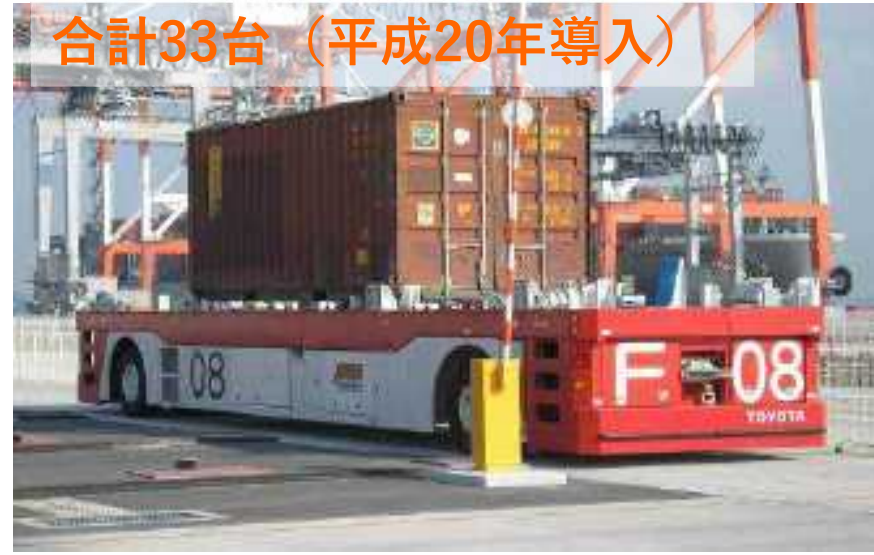
②AGVがコンテナ置き場へ搬送
