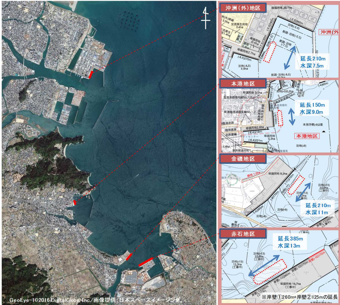
図 2.12 クルーズ船の寄港岸壁と岸壁諸元
