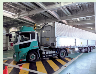
↑ シャーシを船内に積み込むトレーラー（ヘッド+シャーシ）
