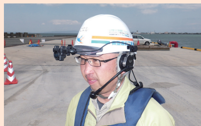
遠隔カメラをヘルメットに装着
