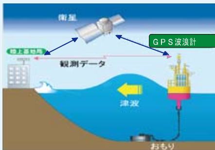
↑ GPS波浪計システムの概要
