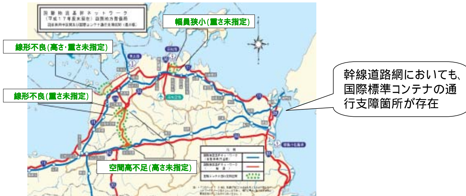
幹線道路のボトルネック箇所(香川県)
