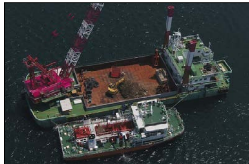
回収した漂流物を瀬取りより陸揚（美讃） （H30.7月西日本豪雨 燧灘海域）
