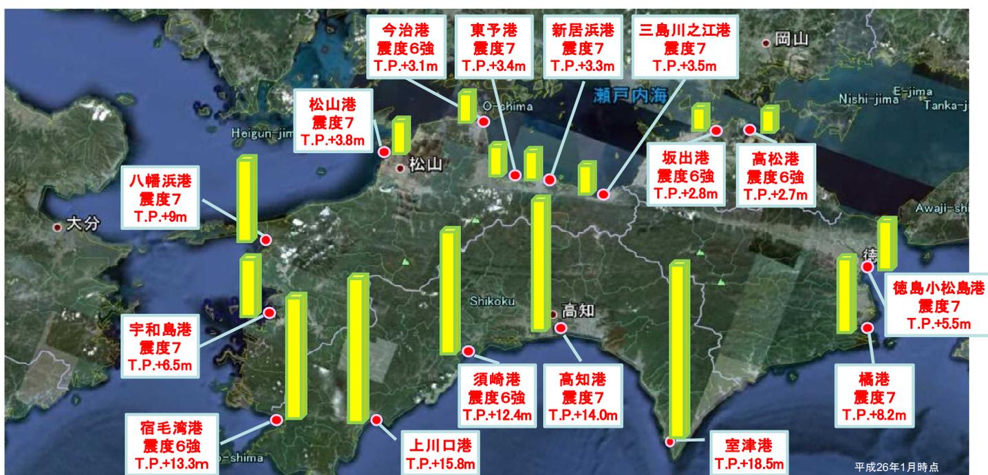
図 南海トラフ巨大地震による重要港湾の震度と津波水位（県想定）
