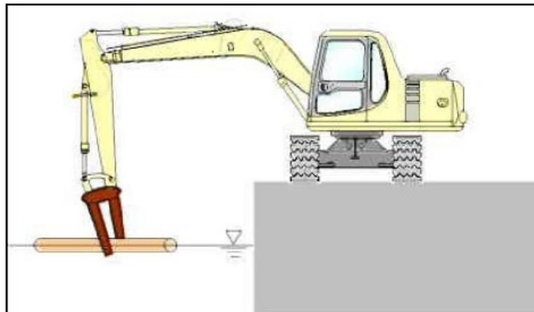
図一参9(1) バックホウ(フォークアタッチメント付き)による浮遊物揚収の状況図
