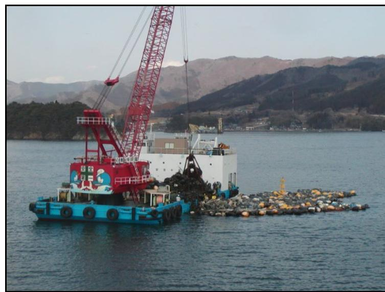
写真一参9(4) 東日本大震災での大船渡港における浮遊物揚収状況
