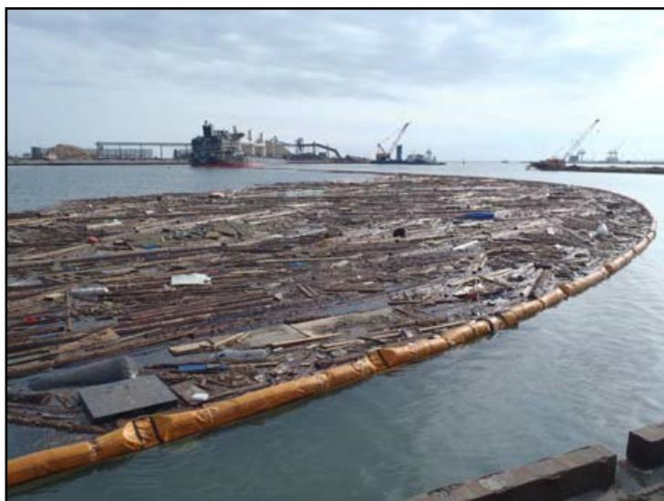
写真一参9(2) 東日本大震災での石巻港における浮遊物囲い込み状況
