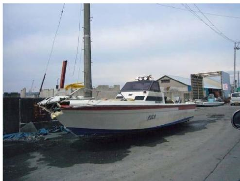
先端のみが損傷している船舶の例
