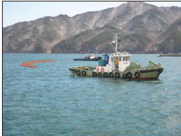
写真一参9(1) 東日本大震災での宮古港における浮遊物囲い込み状況
