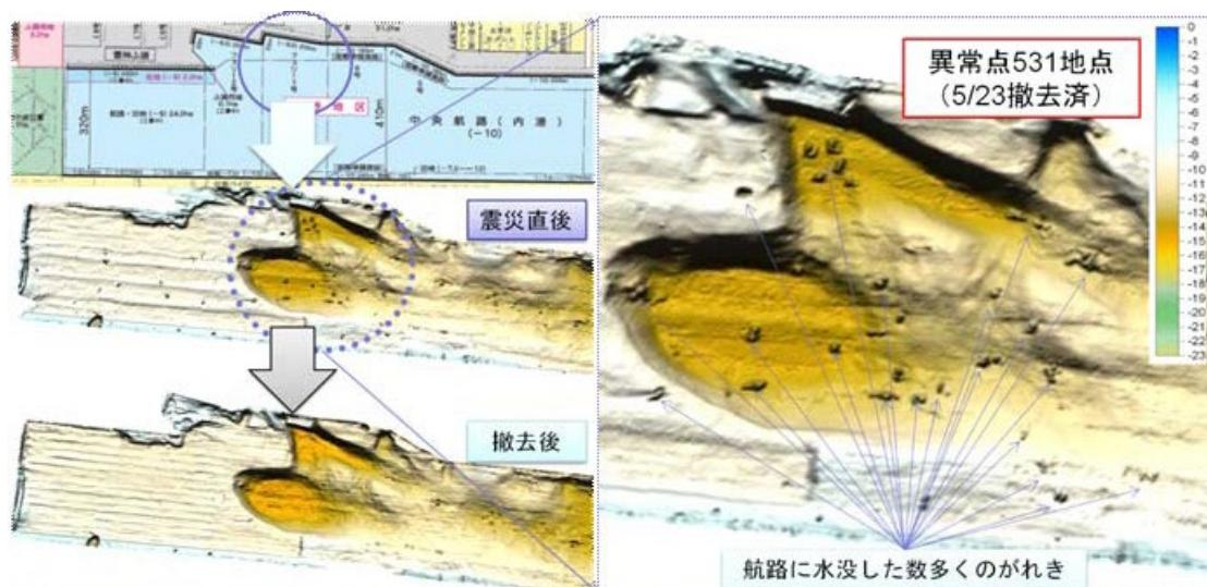
図ー参6(2) 東日本大震災での仙台塩釜港(仙台港区)におけるマルチビーム音響測深成果の一例
