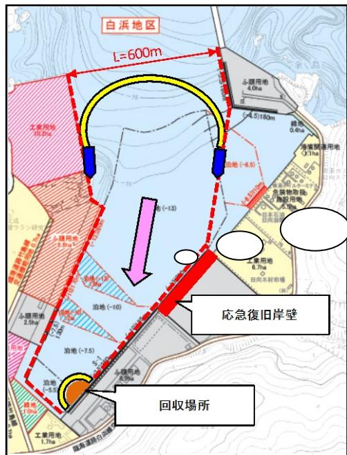
汚濁防止膜を使用して、浮遊物を港外側より囲い込んで港奥部へ曳航し、緊急物資輸送船の航路範囲外に一旦移動させる。
