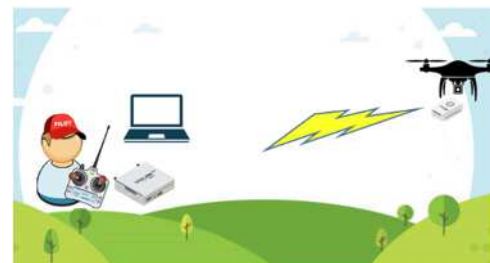
図 外部取り付け送受信機通信イメージ (資料: ジェピコ)
