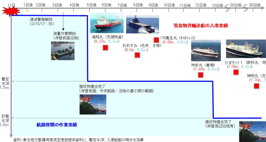
図 仙台塩釜港(仙台区)高松埠頭(耐震強化岸壁)の暫定水深と緊急物資輸送船の喫水との関係
