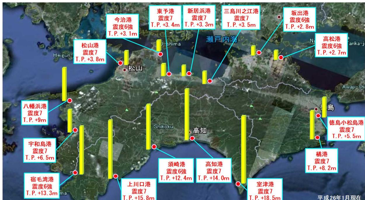
図 南海トラフ巨大地震による重要港湾の震度と津波水位(県想定)
