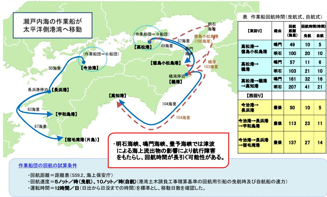
図 濑戸内海側から太平洋側への作業船団の移動に要する所要時間の試算結果
