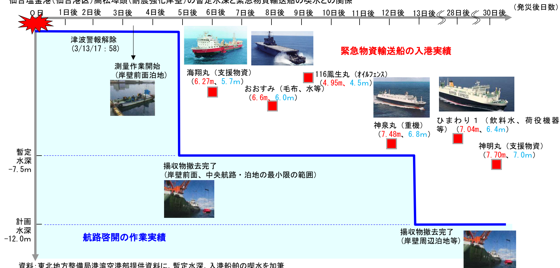
図 仙台塩釜港(仙台港区)高松埠頭(耐震強化岸壁)の暫定水深と緊急物資輸送船の喫水との関係
