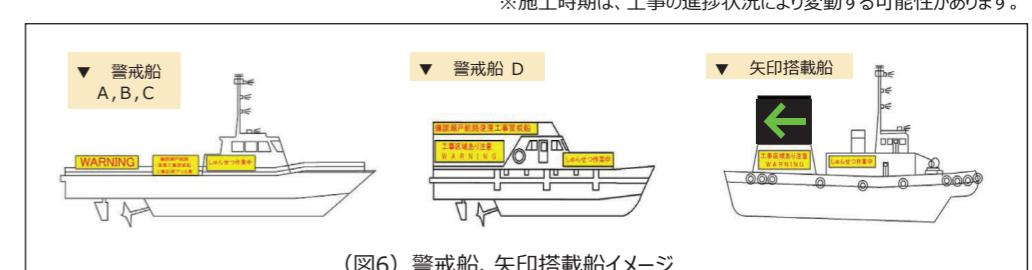
(図6) 警戒船、矢印搭載船イメージ
