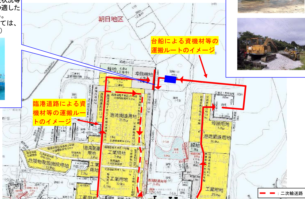
図 応急復旧資機材、要員の調達・運搬のイメージ (朝日地区耐震強化岸壁の例)
