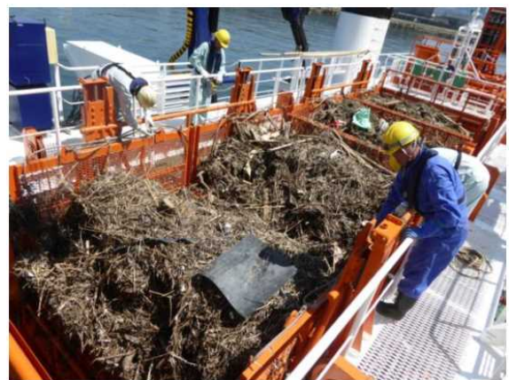
漂流物を回収した「美讃」の回収コンテナ
