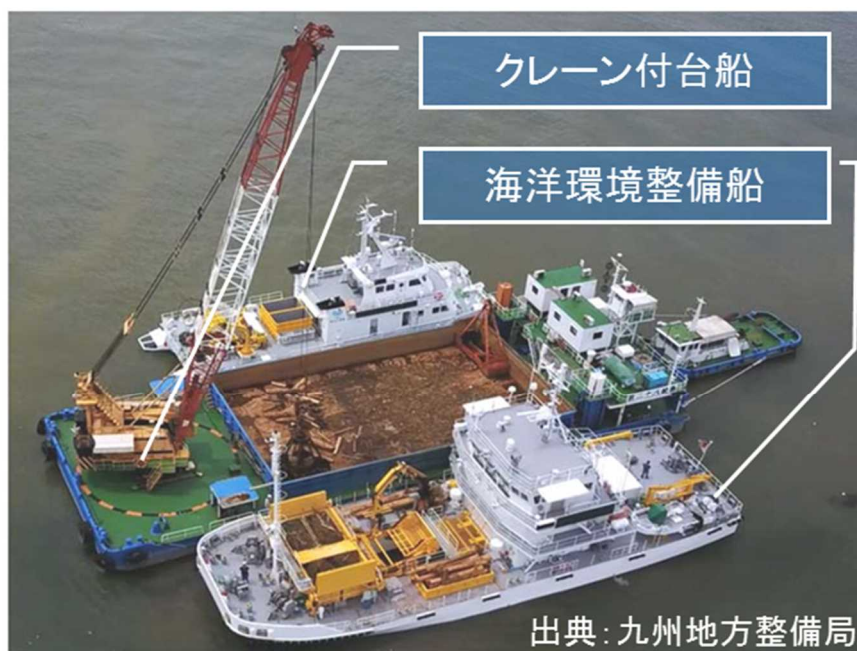
クレーン付台船を用いた漂流物の回収作業 (平成29年度における九州地方整備局の事例)
