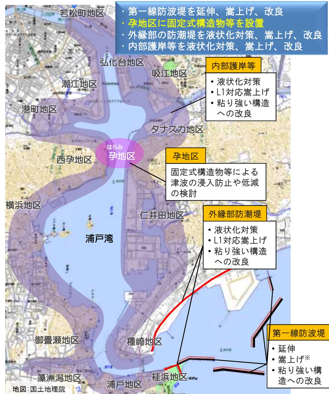
※ 第一線防波堤の嵩上げについては、別途地震時の地盤沈下量を求め、地震後においても港内の静穏度を確保するのに必要な高さに事前対策するものとした。
