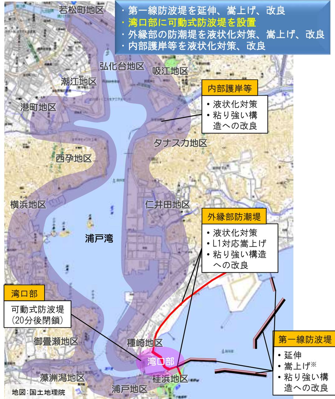
※ 第一線防波堤の嵩上げについては、別途地震時の地盤沈下量を求め、地震後においても港内の静穏度を確保するのに必要な高さ事前に事前対策するものとした。
