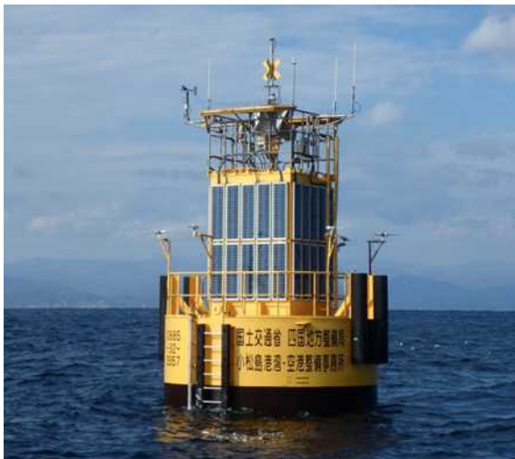
—GPS波浪計測灯浮標 諸元— ブイ全高：約18m（喫水線上8m）
