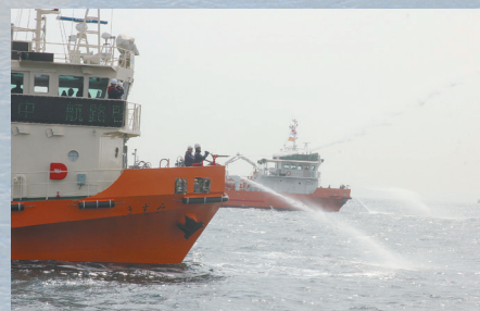
↑ 浮遊油の放水拡散
