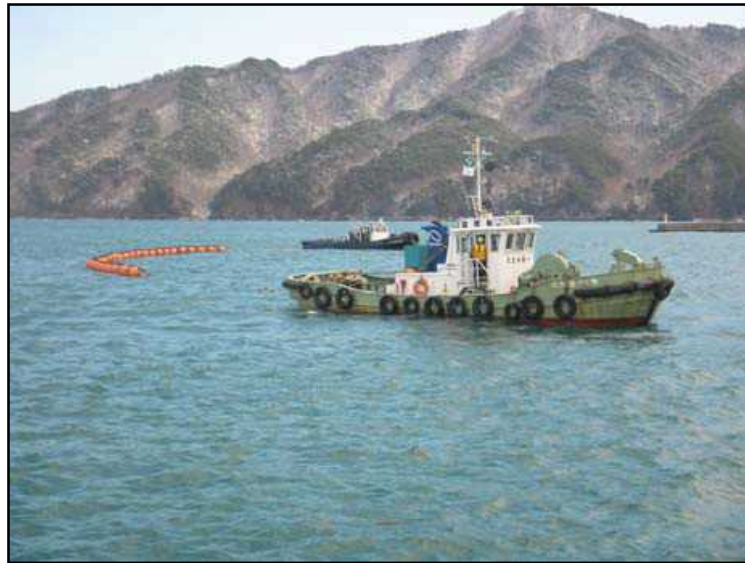
写真. 参-4.1 東日本大震災での宮古港における浮遊(漂流)物囲い込み状況
