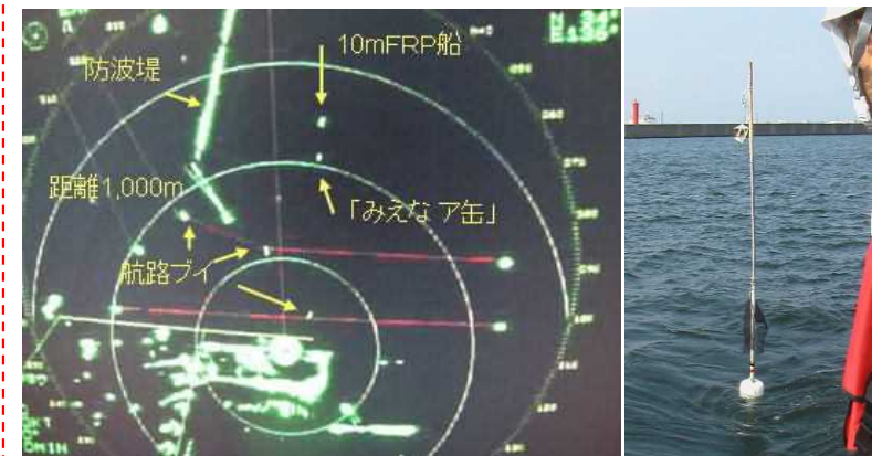
図 簡易レーダー反射器「みえな ア缶」とレーダ映像
