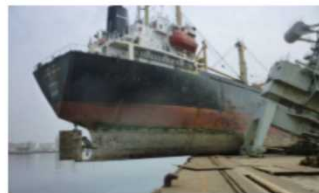
船舶の岸壁への乗揚げ事例 (仙台塩釜港)
