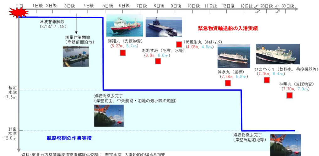
図 仙台塩釜港(仙台港区)高松埠頭(耐震強化岸壁)の暫定水深と緊急物資輸送船の喫水との関係
