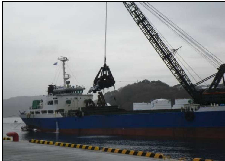
(ガット船による車のバケット揚収)
