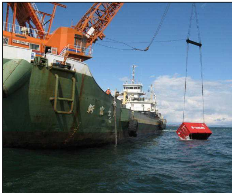
(起重機船によるコンテナの玉掛け揚収)
