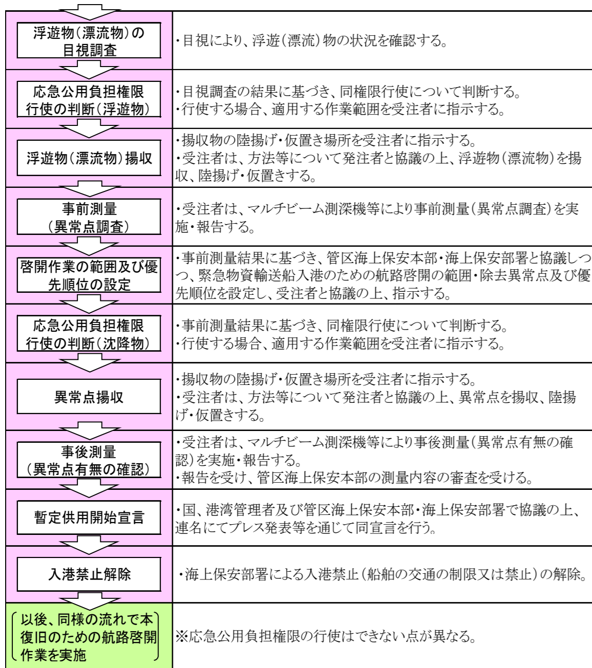
図-1.3(2) 発災時の航路啓開作業の基本的な手順
