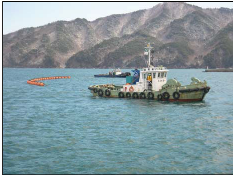
写真－参9(1) 東日本大震災での宮古港における浮遊物囲い込み状況
