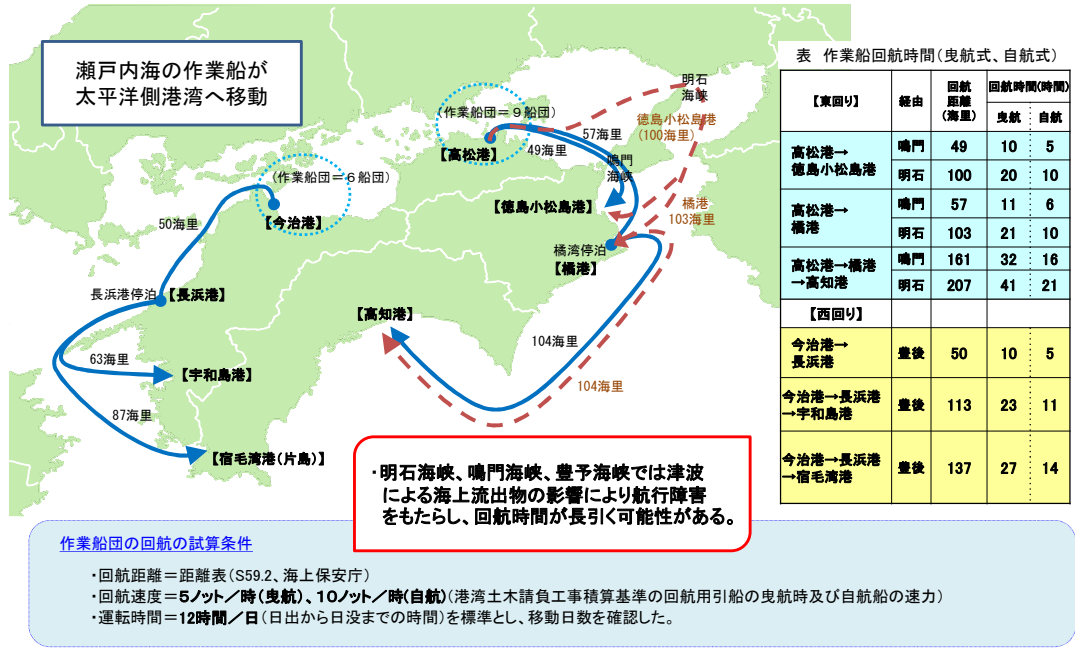
図 瀬戸内海側から太平洋側への作業船団の移動に要する所要時間の試算結果
