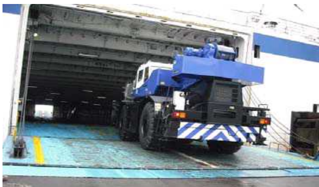
瀬戸大橋を通行できない長大物 (ラフテレンクレーン)の海上輸送
